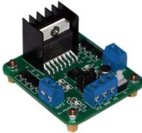
Рис. 1.27. Драйвер двигуна L298N
