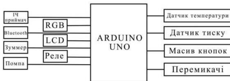
Рис. 3.2. Схема електрична принципова
