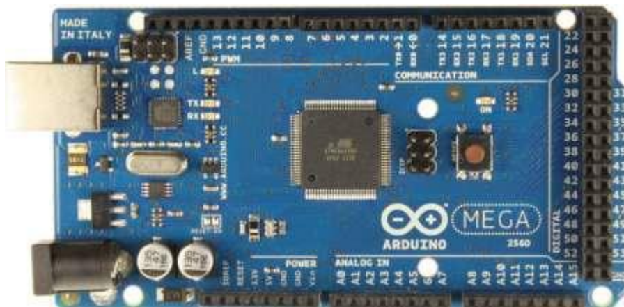
Рис. 1.2. Мікроконтролер Arduino Mega 2560
