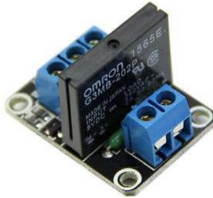
Рис. 1.23. Твердотільне реле
